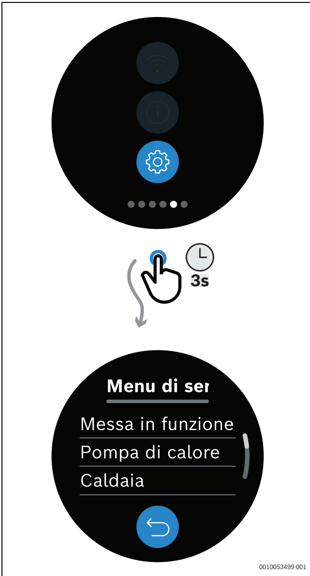
Fig. 27 Accesso al Menu di servizio.
